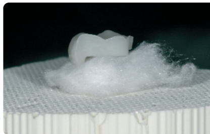
Поместить на трегер с сотовой структурой объекты и запустить программу обжига.
