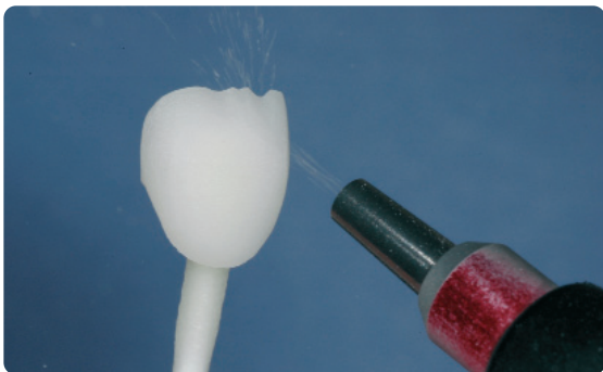
Почистить реставрацию в пескоструйном аппарате, используя оксид алюминия Al 2 O 3 при давлении 0,5 бар (осторожно: абразивность)
